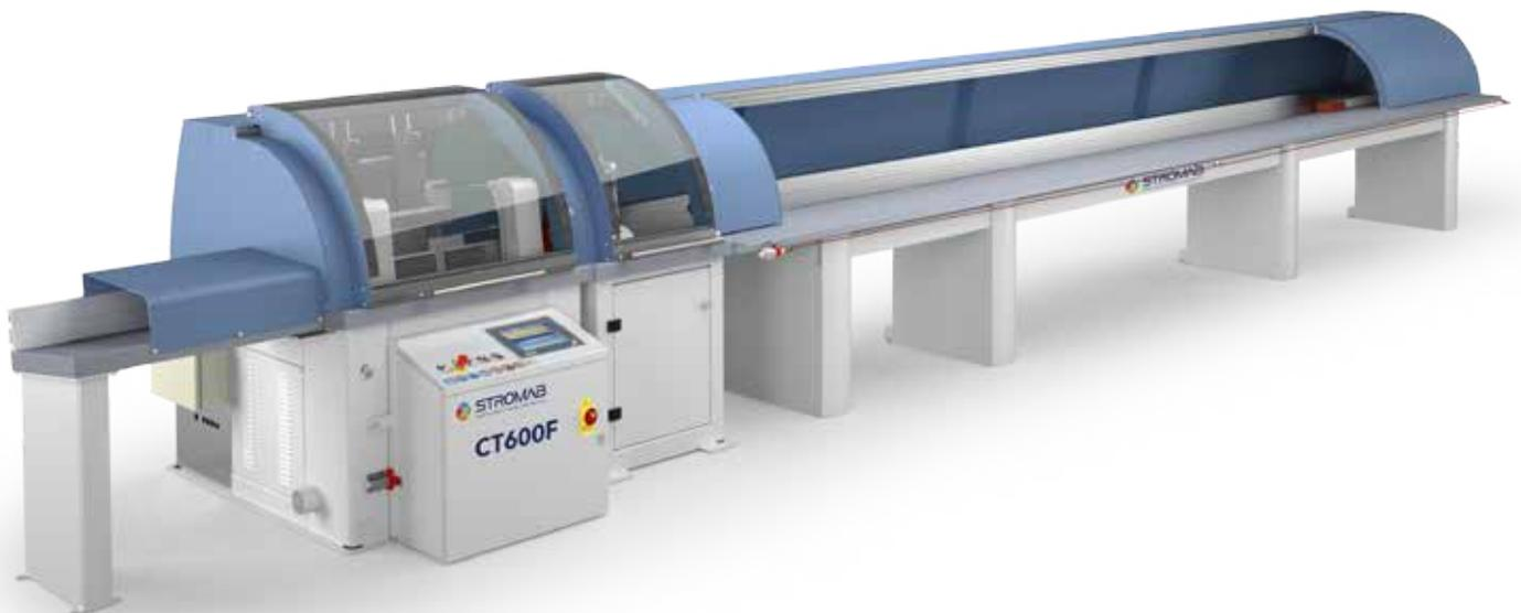
BECKHOFF-Steuerung mit hochauflösendem 12" Touch-Screen Monitor und 3D-Grafik-Schnittstelle mit Windows-Betriebssystem.
